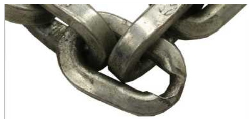
Ketjun lenkki on voimakkaasti kulunut.
