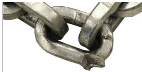
Ketjun lenkki on vaurioitunut mekaanisesti.
